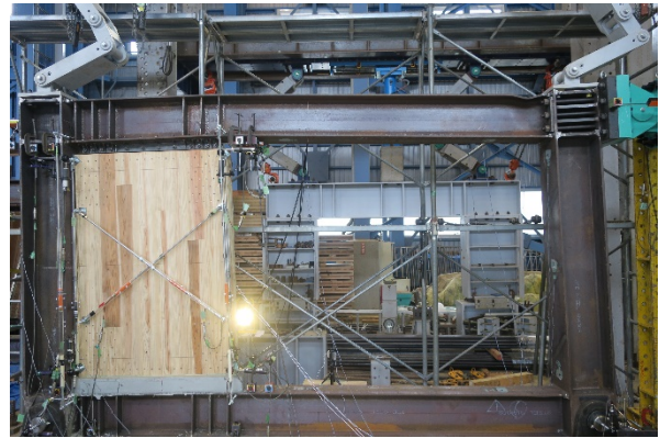
(4) 1/30rad 負側鉄骨局部座屈・面外変形
