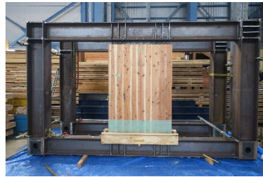
モルタル型枠施工
