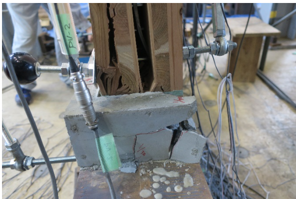
(5) 引き壊し中 1/15radCLT モルタル圧壊
