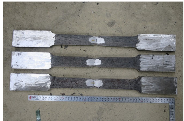
写真 2.3.3-1(d) 試験後写真 B-4～B-6 柱フラ ンジ
