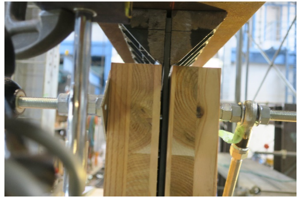
(2) 1/75rad 挿入鋼板すべり
