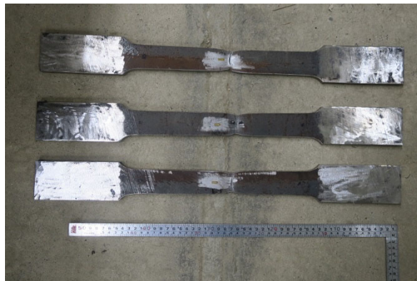
写真 2.3.3-1(c) 試験後写真 B-1～B-3 柱ウェ ブ
