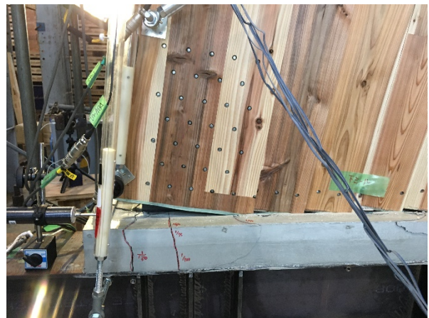
(6) 試験終了後 CLT 下部挿入鋼板破断
