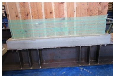
型枠取り外し後
