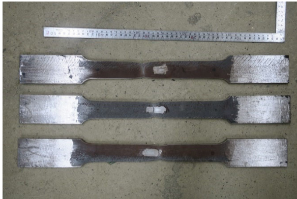
写真 2.3.3-1(a) 試験後写真 A-1～A-3 梁ウェ ブ
