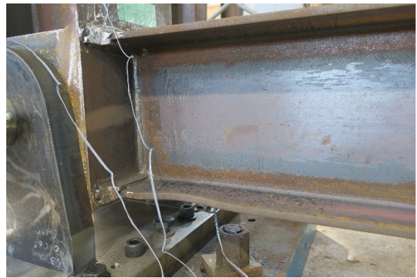
(4)1/30rad 荷重負側 下梁端部局部座屈
