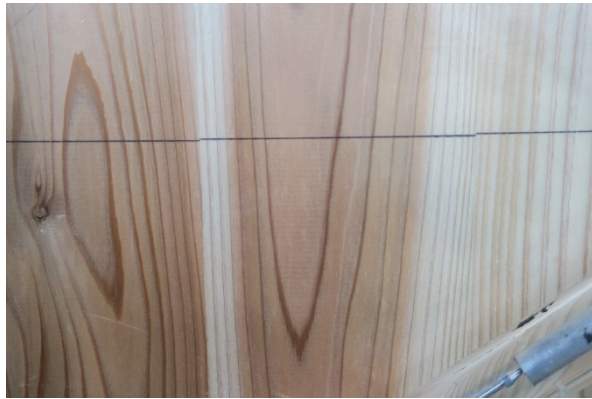
(3) 1/30radCLT せん断変形
