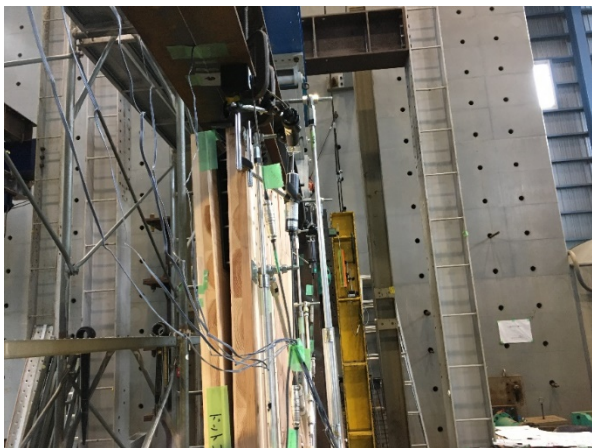
(5)引き壊し中 ドリフトピン接合部 CLT の開き
