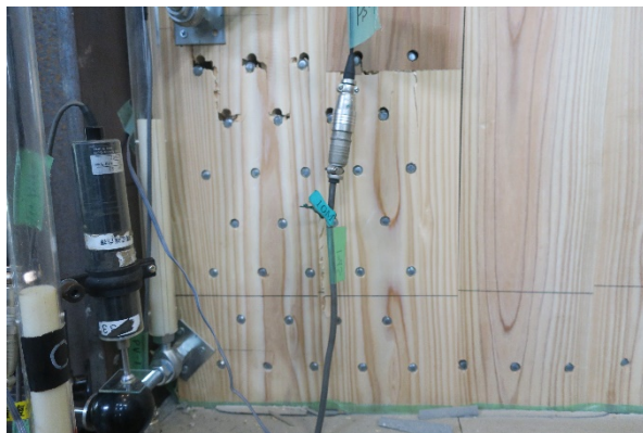
(5) 引き壊し中 CLT 集合型引張破壊
