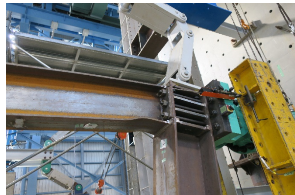
(6)最大変形時 上梁局部座屈
